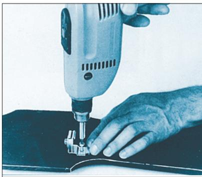
▲ Balkonverkleidung von innen einhängen, leicht anziehen und durch einfaches Verschieben einteilen.
